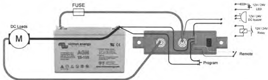
Obrázek 2: Schéma zapojení BP-65 BP-100 a BP-220
