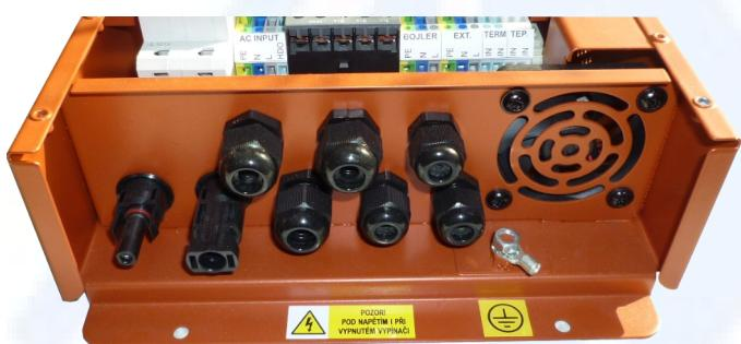
**Přístroj je možné přizemnit k vnější ochranné svorce (napravo od průchodek) vodičem o dostatečném průřezu, avšak pouze přímo na svorkovnici PE v soustavě TNS nebo PEN v soustavě TNC v hlavním rozvaděči.**
