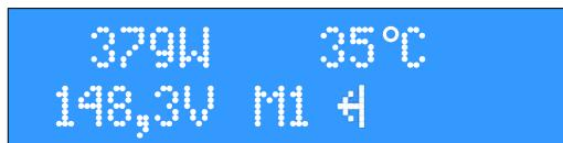
Pokud je zobrazen souhrnný displej, je možné přepnout modulaci do externího výstupu také ručně krátkým stiskem tlačítka MODE (např. pokud již nechcete ohřívat bojler, ale chcete nadále spotřebovávat sluneční energii v připojeném přímotopu). Manuální přepnutí do externího výstupu je signalizováno na displeji značkou postavičky na pozici 3 (čl.6.2)
