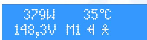
V režimu ručního zapnutí do externího výstupu zůstane zařízení až po jeho vypnutí opětovným krátkým stiskem tlačítka MODE při zobrazeném souhrnném displeji.
